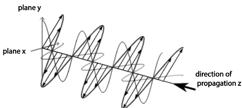
Obr. 2.2. Rozloženie optického signálu do dvoch polarizačných rovín
