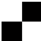
Obr. 2. 3 - Vzor šachovnice používaný na subpixelovú detekciu X-rohových bodov
