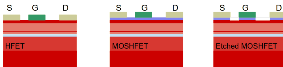
Obr. 5: Schematické priečne rezy HFET-u, MOSHFET-u s vrstvou \text{AlO}_x a leptaného MOSHFET-u, prevzaté z [36].
