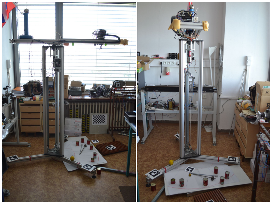
Obr. 2.1: Vytvorený fyzikálny model vežového žeriavu
