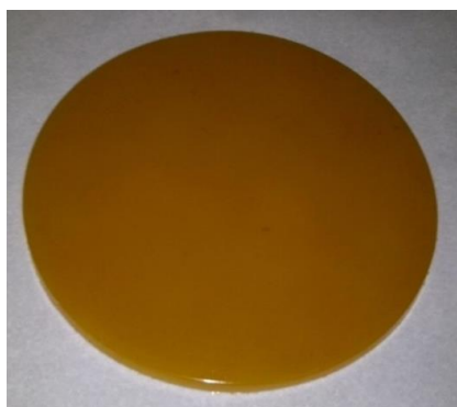
Obr. 3.5 Model S1 – dielektrikum bez porúch (detail)
