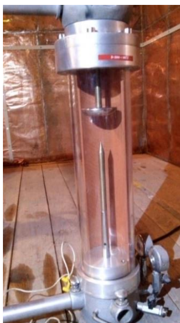
Obr. 3.12 Model S8 - koróna 1: doska VN / hrot uzemnený
