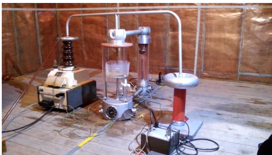
Obr. 3.14 Merací obvod s dvomi rôznymi poruchami
