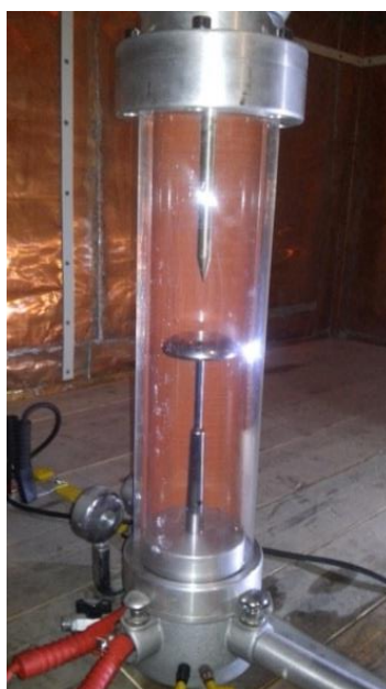
Obr. 3.10 Model S7 – koróna 1: hrot VN / doska uzemnená
