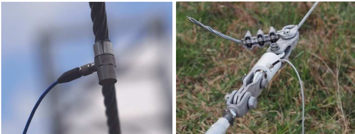
Obr. 8.3 Piezoelektrický akcelerometer uchytený na lanovom vodiči (vľavo), uchytený tenzometrický snímač sily na sledovanie osovej sily v lanovom vodiči (vpravo)
