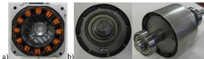
Obr. 1 Prototyp BSM s koncentrickým vinutím
