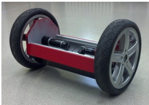
Obr. 2.1 Reálna konštrukcia mobilného robotického podvozku typu AMAV, ešte bez výsuvnej platformy
