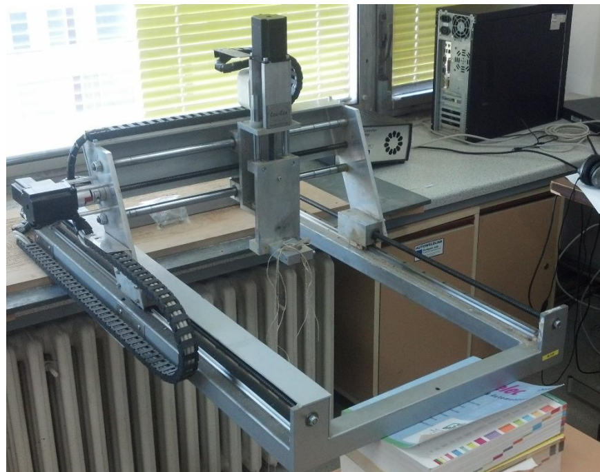
Obr. 7.2 Fotografia modelu žeriava vytvoreného úpravou frézy
