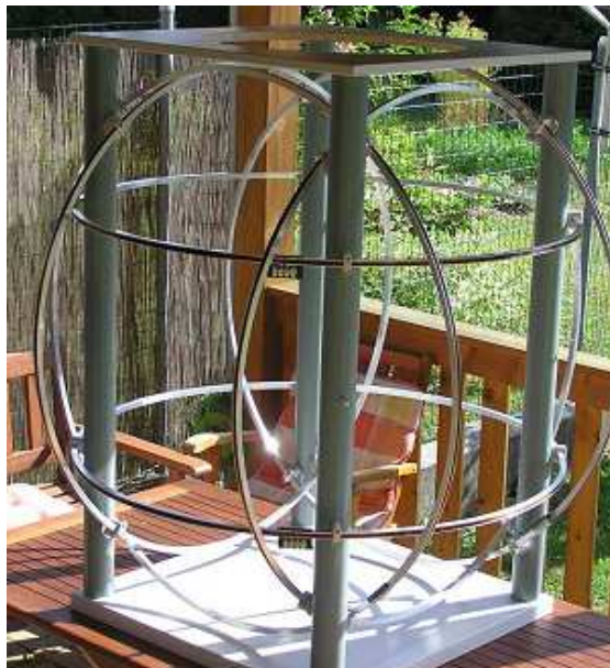
Obr. 32. Sústava Helmholtzových cievok
