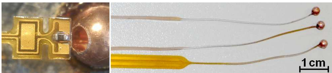
Obr. 5: Konštrukcia (vľavo) a 3 hotové hot-ball senzory na báze flexibilných plošných spojov
