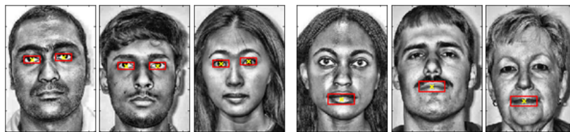
Obr. 4.2: Testovacie obrazy z [FADA] po aplikovaní CLAHE. Príklady úspešnej lokalizácie očí a úst [5].
