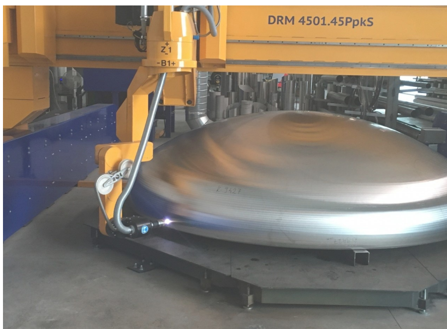
Obrázok 3: Pri zložitých 3D rezoch je pákový efekt výrazný a je problém dosiahnuť žiadanú kvalitu rezu pri zrýchleniach a rýchlostiach vyžadovaných technológiou
