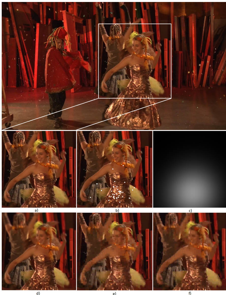
Obrázok 11 – Výsledok procesu kódovania snímky s využitím navrhutej metódy: a) originálna snímka, b) originálna snímka so zobrazením polohy pohľadu, c) mapa význačnosti pre snímku vytvorenú z polôh pohľadu, d) snímka po aplikácii Gaussového filtra pre rozmazávanie, e) snímka originálneho videa kódovaného kodekom x264 s bitovým tokom 1,5 Mbps, f) snímka upraveného videa pri \sigma_h = 0,15 kódovaného kodekom x264 s bitovým tokom 1,5 Mbps.
