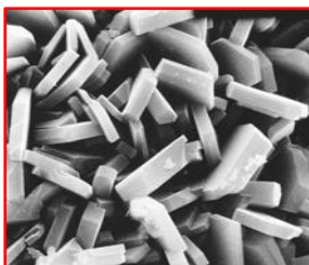
Obr. 4.3 Vzorka prírodného zeolitu z najvýznamnejšieho slovenského priemyselne využívaného ložiska v Nižnom Hrabovci.
