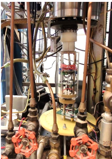
Obr. 3.9 Kombinovaný merač teploty inštalovaný v aparátúre HF CVD reaktora.
