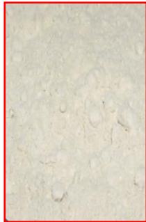
Obr. 4.1 Vzorka čistého montmorillonitu použitá ako substrát na syntézu CNTs. Ílový minerál MMT bol separovaný z bentonitu zo slovenskej lokality Stará Kremnička – Jelšovský Potok.
