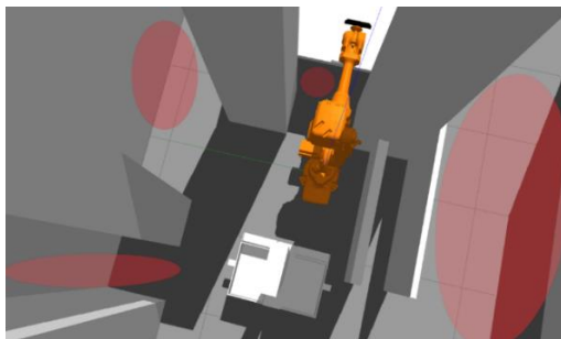
Obr. 5.8 Ilustrácia simulačného prostredia vľavo a oktálového stromu neznámeho a obsadeného priestoru po počiatočnej fáze vpravo.
